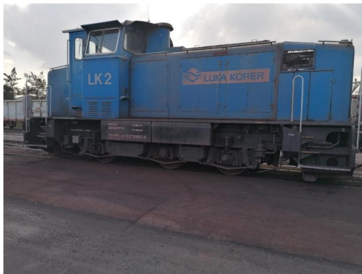
Slika 1: Lokomotiva LOK02 MAK G700C
